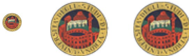
Figura 51: Effetto della visualizzazione ingrandita di un'immagine bitmap codificata con una risoluzione molto bassa (a sinistra): appare evidente la forma quadrata del pixel stesso (al centro).
