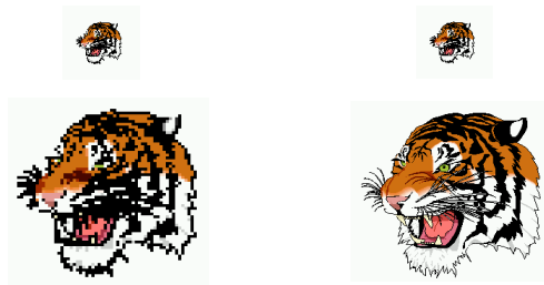
Figura 52: Differenza tra grafica bitmap e grafica vettoriale: se quando l'immagine è piccola la rappresentazione è uguale, dopo l'ingrandimento la prima (a sinistra) presenta la caratteristica quadrettatura, la seconda ha un contorno definito finemente.
