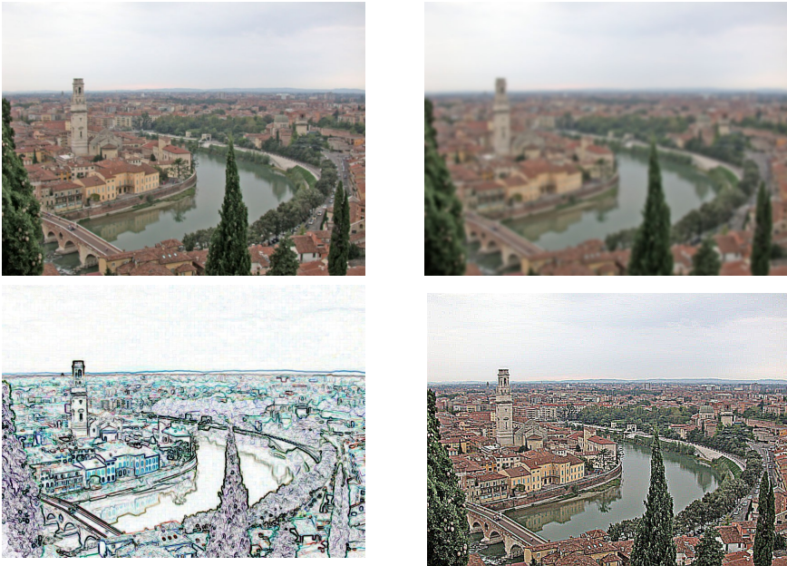
Figura 59: Effetto di operazioni locali di filtraggio. In alto a sinistra: immagine originale, in alto a destra: sfocatura Gaussiana, in basso a sinistra: rilevamento contorni, in basso a destra: affilatura.
